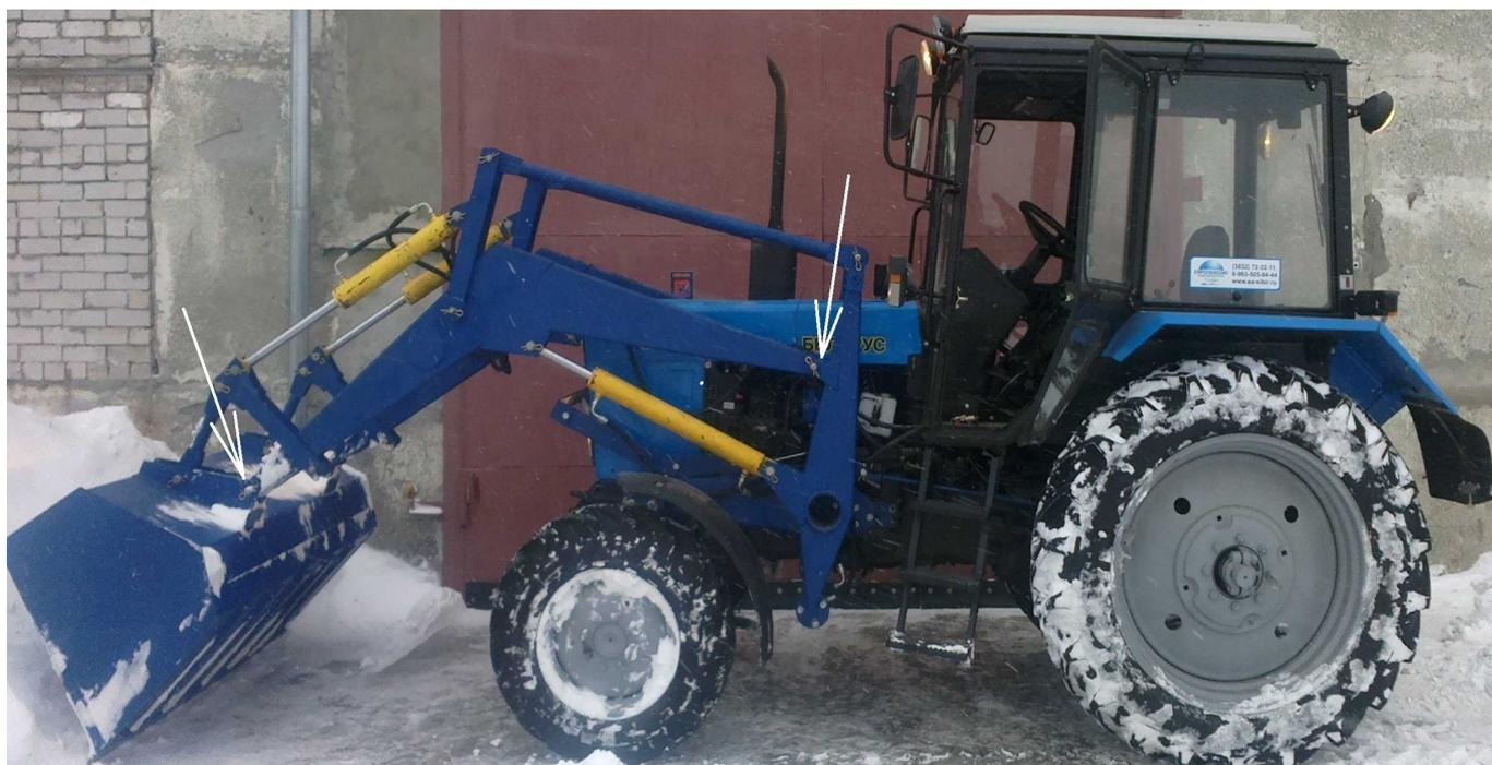
Рис. 11 — Схема смазки.
