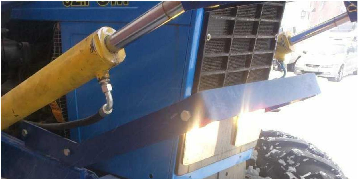
Рис. 5 - Установка ограждения радиатора.
